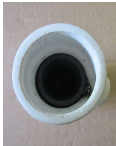
Фиг. 2. 1 б) тигел с графитна вложка
