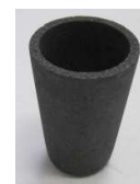
Фиг. 2. 1 б) тигел с графитна вложка
