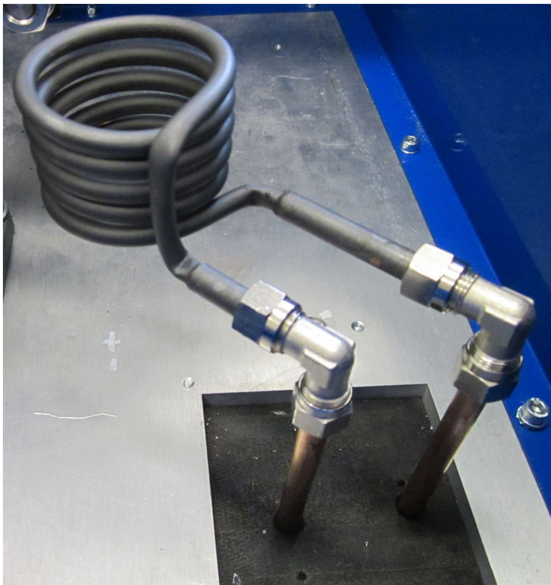
Фиг. 4. 4 а) Горно положение на индуктора
