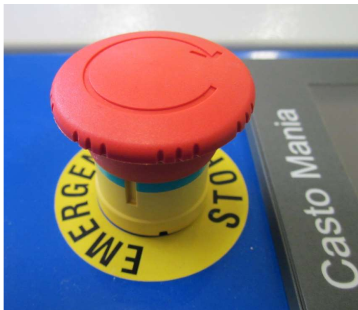
Фиг. 5. 3 Аварийен стоп бутон
