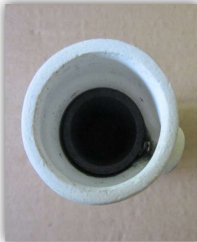
Фиг. 2. 1 б) тигел с графитна вложка
