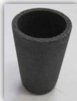
Фиг. 2. 1 б) тигел с графитна вложка
