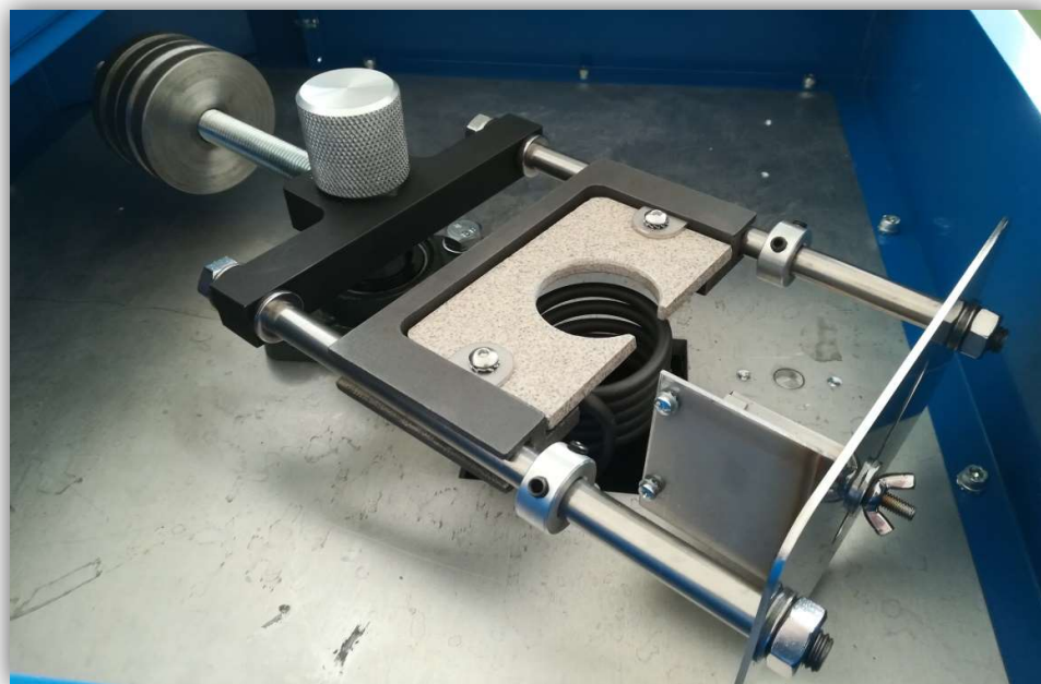
Фиг. 4. 5б) Монтиране на рамото на въртележката с фиксиращата гайка.
