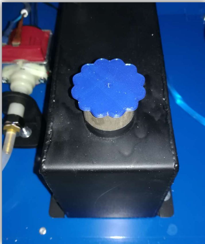
Фиг. 4. 6 Резервоар за вода, вместимост 10 литра
